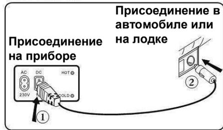
Один конец **кабеля DC** подключить к присоединению DC прибора ①, а второй конец ② к гнезду прикуривателя, напр., в автомобиле или на лодке.
