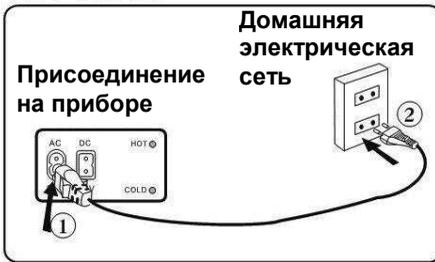
Один конец **кабеля AC** подсоединить к присоединению AC прибора ①, а второй конец ② к гнезду домашней электрической сети.
